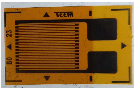
FIG. 4 : Jauge de déformation : résistance variant selon son élongation 4 .
